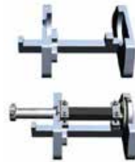
(上) サンプルアライメントジグ (下) ジグを用いてDMAアクセサリにサンプルを取り付けた状態
