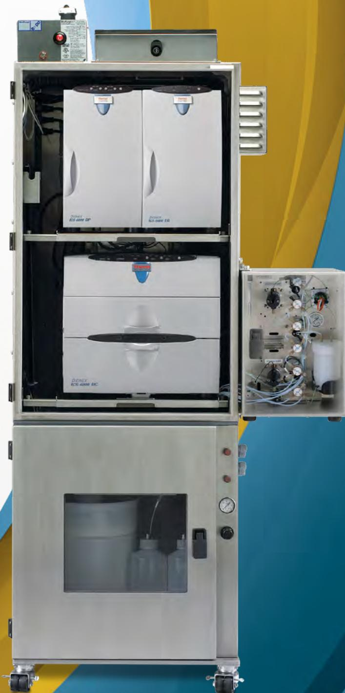
LE モジュール上部の外面に SP モジュールを取り付けた、AE モジュール内の IC システム
