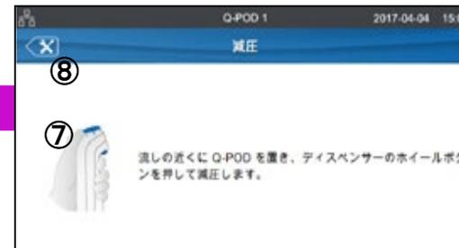
⑦ホィールボタン(採水スイッチ)を押し、水が出なければ、減圧完了です。⑧その後、画面を戻り、ホームボタンを押す。工具マークの画面が表示されます。
